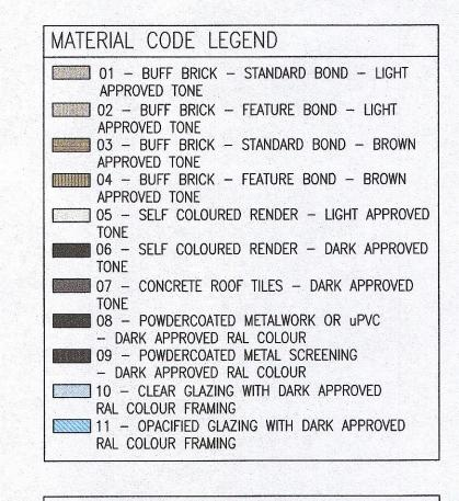
REFER TO STREET **ELEVATIONS FOR LOCATION OF ELEVATION TYPES**
