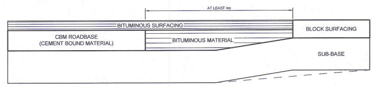
BITUMINOUS SURFACING TO BLOCK SURFACING (NO ROAD BASE)
