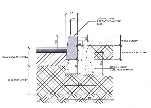
TYPICAL PRECAST CONCRETE KERB DETAIL
