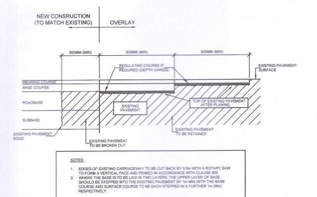
LONGITUDINAL JOINT BETWEEN NEW CONSTRUCTION AND EXISTING ROAD
