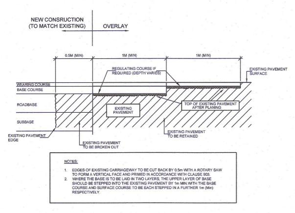
TRANSVERSE JOINT BETWEEN NEW CONSTRUCTION AND EXISTING ROAD
